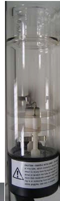
Schema einer Hohlkathodenlampe, Quelle (Mai 2022): J Wesener (RÖMPP, Thieme), https://roempp.thieme.de/lexicon/RD-08-01599
