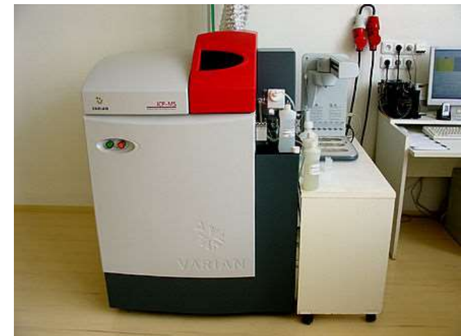
ICP-MS-Gerät (stand-alone, Varian)
